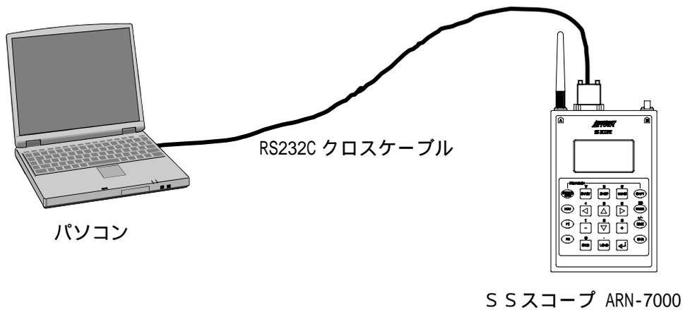
COM ポートに接続する場合 RS-232C/USB 変換機等を使用する場合には、COM ポート をご確認ください。
